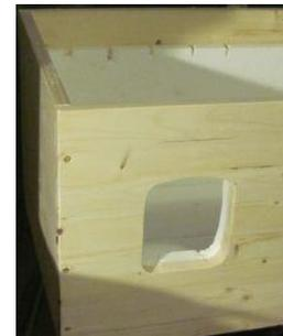
**6.** Eingang ca. 10- 15 cm über dem Boden anzeichnen und aussägen, Kanten glätten. Der Eingang sollte der Kaninchengröße angepasst, aber möglichst klein sein, damit die Wärme im Haus bleibt
