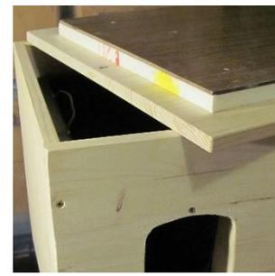
**15.** Unter dem Deckel kommt eine Hartfaserplatte, dazwischen eine Styroporplatte (etwas kleiner als die Bodenplatte). Sie werden miteinander verschraubt.
