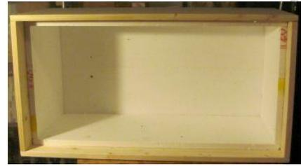
**3.** Styropor zuschneiden und in die Kiste schieben. Die Isolation geht bis unter den Rand der Mörtelbox.
